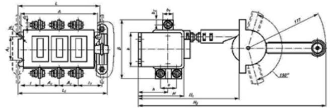
Рисунок 1в. VP32 с передней смещенной рукояткой, 1 направление
